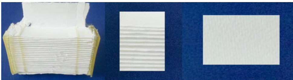
Figura 2. Lámina plegada interna del filtro mecánico.
